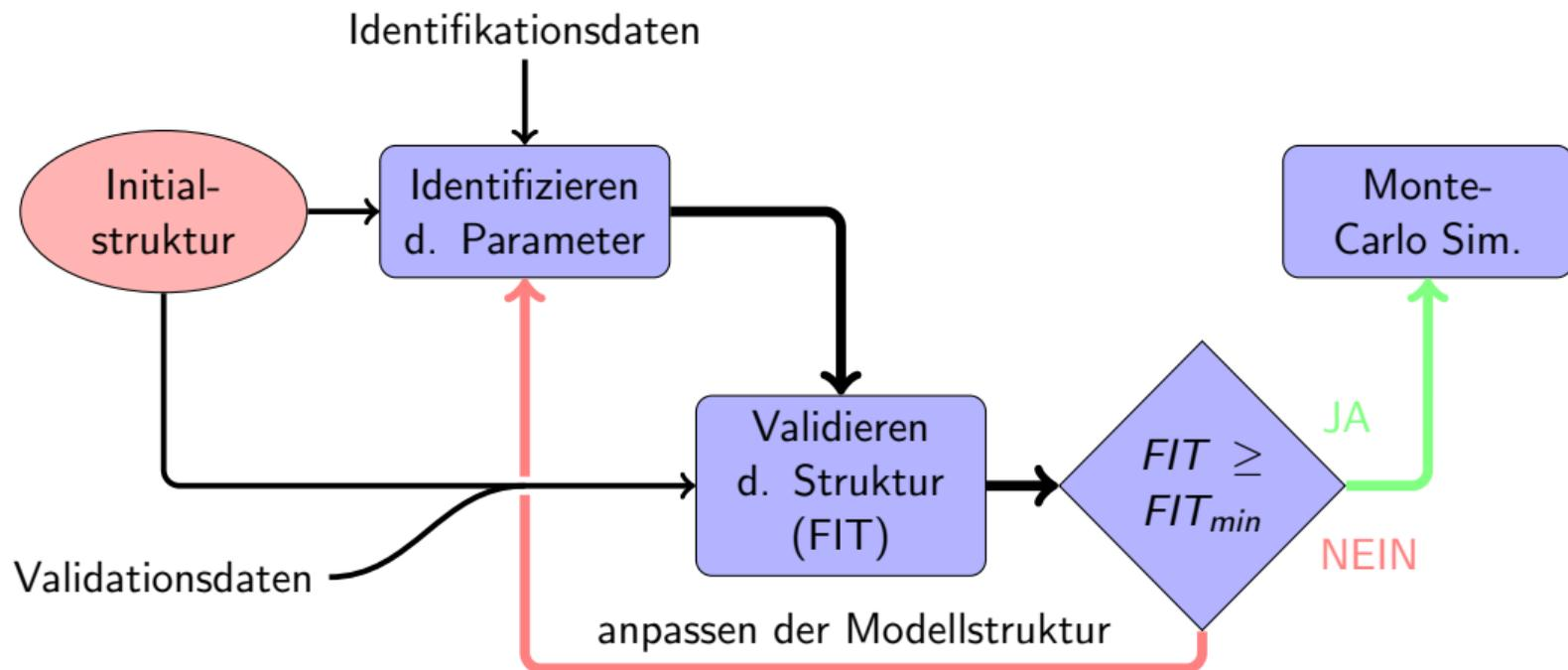
Figure: Ablaufdiagramm: iterative Modellstrukturauswahl
