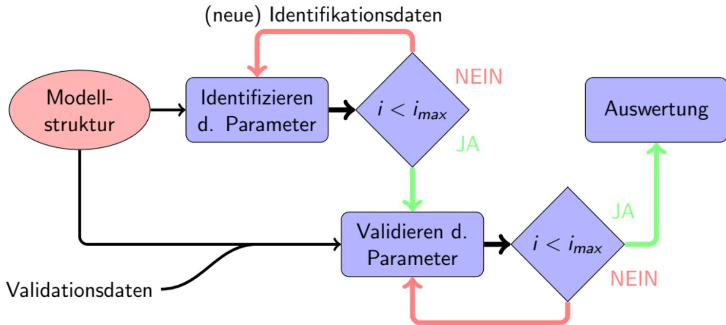
Figure: Ablaufdiagramm: Studien an parametrischen Modellen
