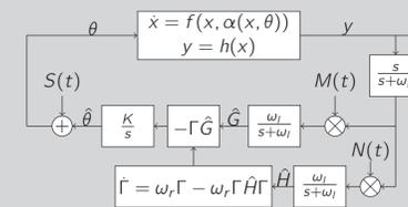
Das allgemeine nichtlineare System selbst sei stabil oder beinhaltet ein stabilisierendes Regelgesetz  $u = \alpha(x, \theta)$ . Die Schätzwerte für Gradient  $\hat{G}$  und Hesse Matrix  $\hat{H}$  werden durch Demodulation mit geeigneten  $M(t)$  und  $N(t)$  berechnet. Die Schätzwerte  $\hat{G}$  und  $\hat{H}$  approximieren damit im Mittel die wahren Werte. Die sinusförmigen Störsignale sind im Vektor  $S(t)$  zusammengefasst.
